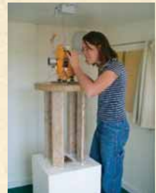
Une mesure au théodolite.
